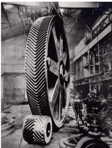
En 1912, il monte la Société d'engrenages Citroën d'où sortira le plus grand engrenage jamais réalisé, une grande roue de 5.4 m de diamètre pesant 8 tonnes. Cet engrenage, commandé par la Compagnie des Forges Chatillon-Commentry, pouvait transmettre une puissance de 2 000 à 4 000 chevaux à 30 tr/min.
